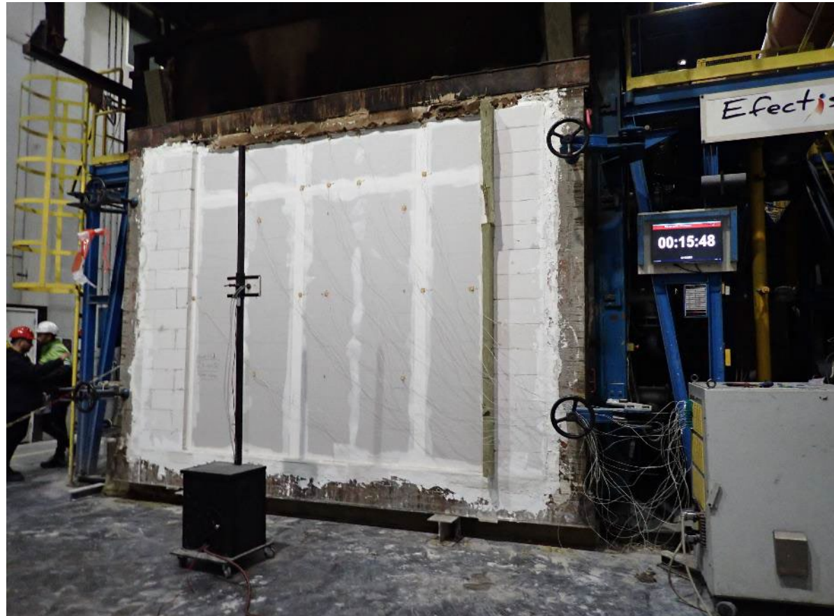
Foto C. 5: Proefstuk na 15 minuten verhitting
