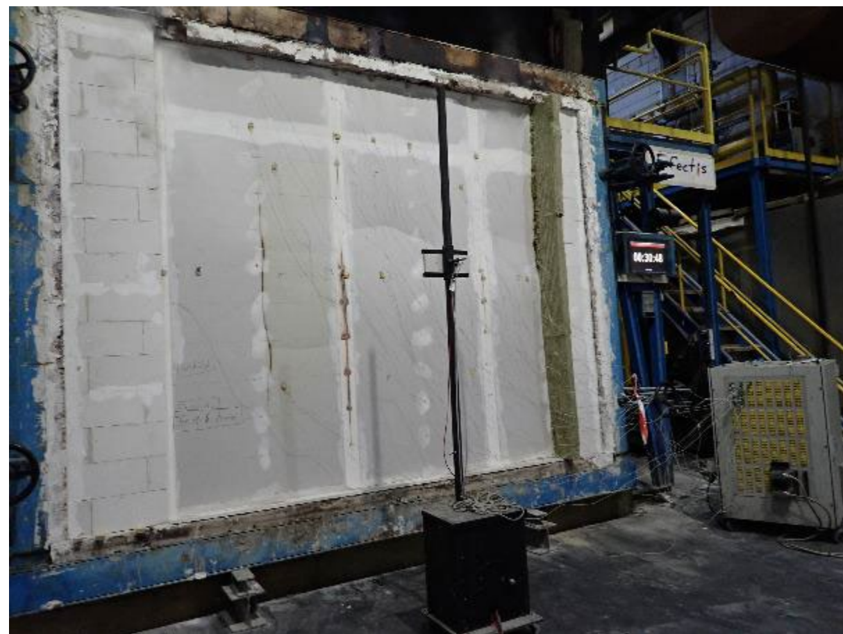
Foto C. 7: Proefstuk na 30 minuten verhitting
