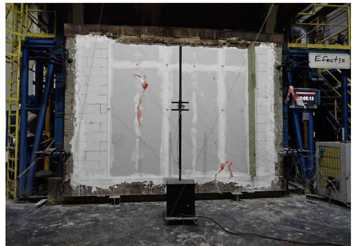
Foto C. 4: Proefstuk na 5 minuten verhitting
