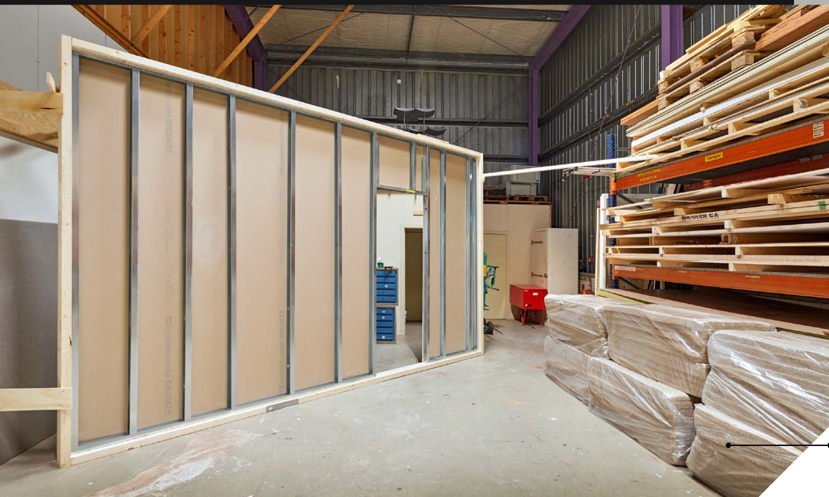
Afbeelding 2 - Testopstelling metal stud wand in werkplaats van JP van Eesteren
