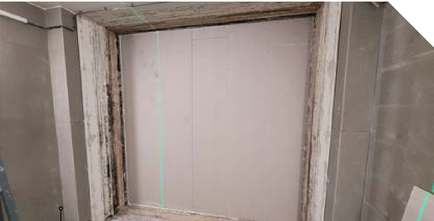
Afbeelding 11 - Afgewerkte wand voor geluidstest
