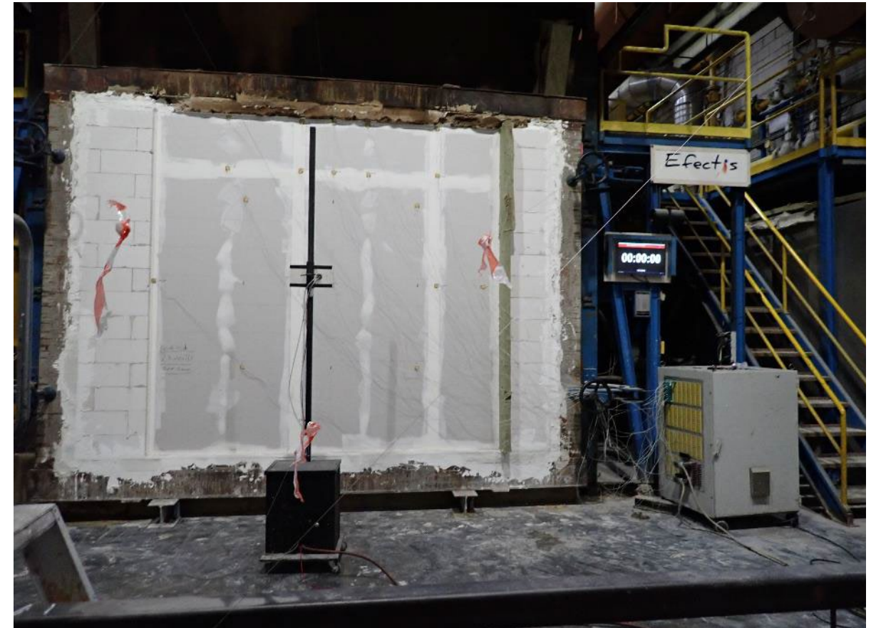
Foto C. 3: Proefstuk voor de aanvang van de test
