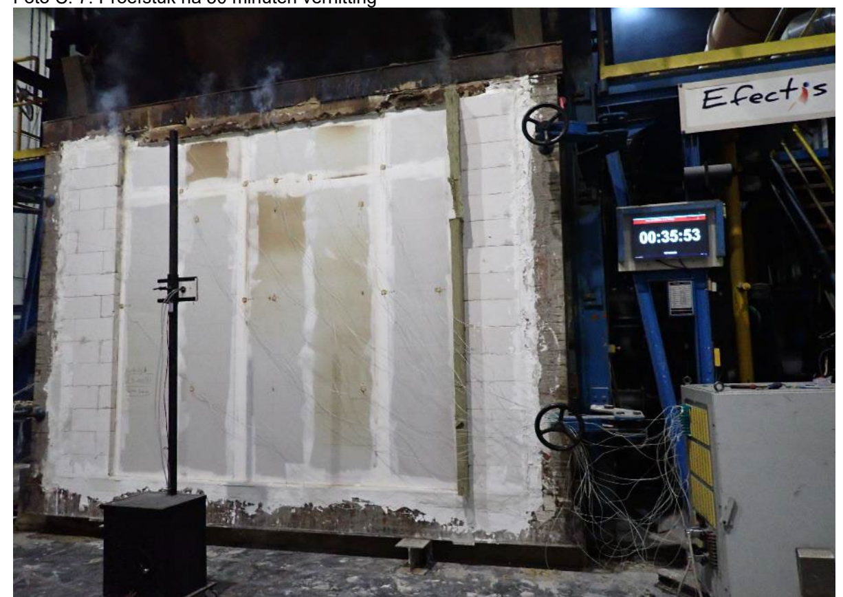
Foto C. 8: Proefstuk na 35 minuten verhitting
