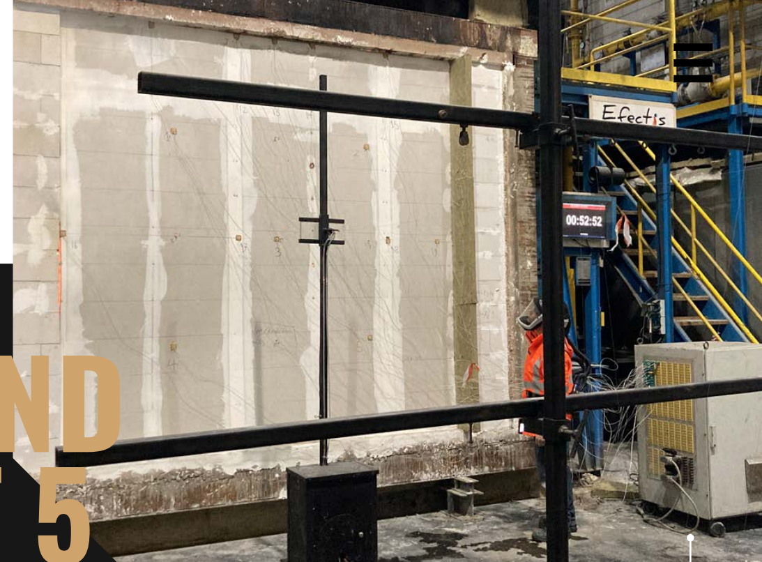
Afbeelding 9 - Brandtest 5 op dubbele metal stud wand
