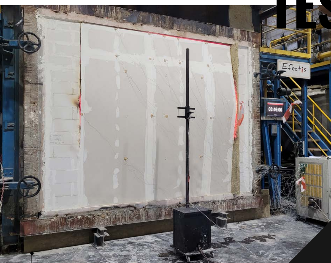
Afbeelding 6 - Brandtest 2 op houtskeletbouw wand
