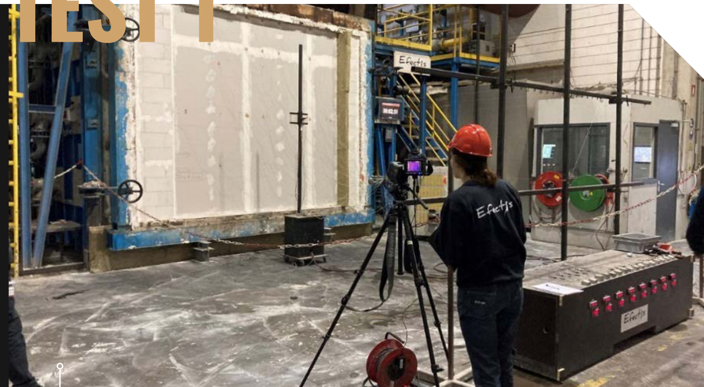
Afbeelding 5 – Brandtest 1 op metal stud wand
