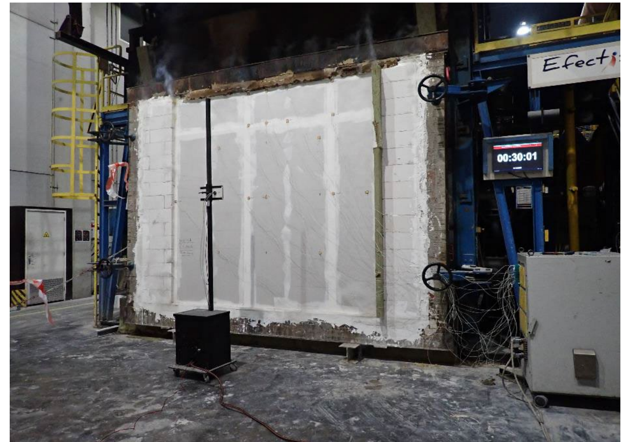
Foto C. 7: Proefstuk na 30 minuten verhitting
