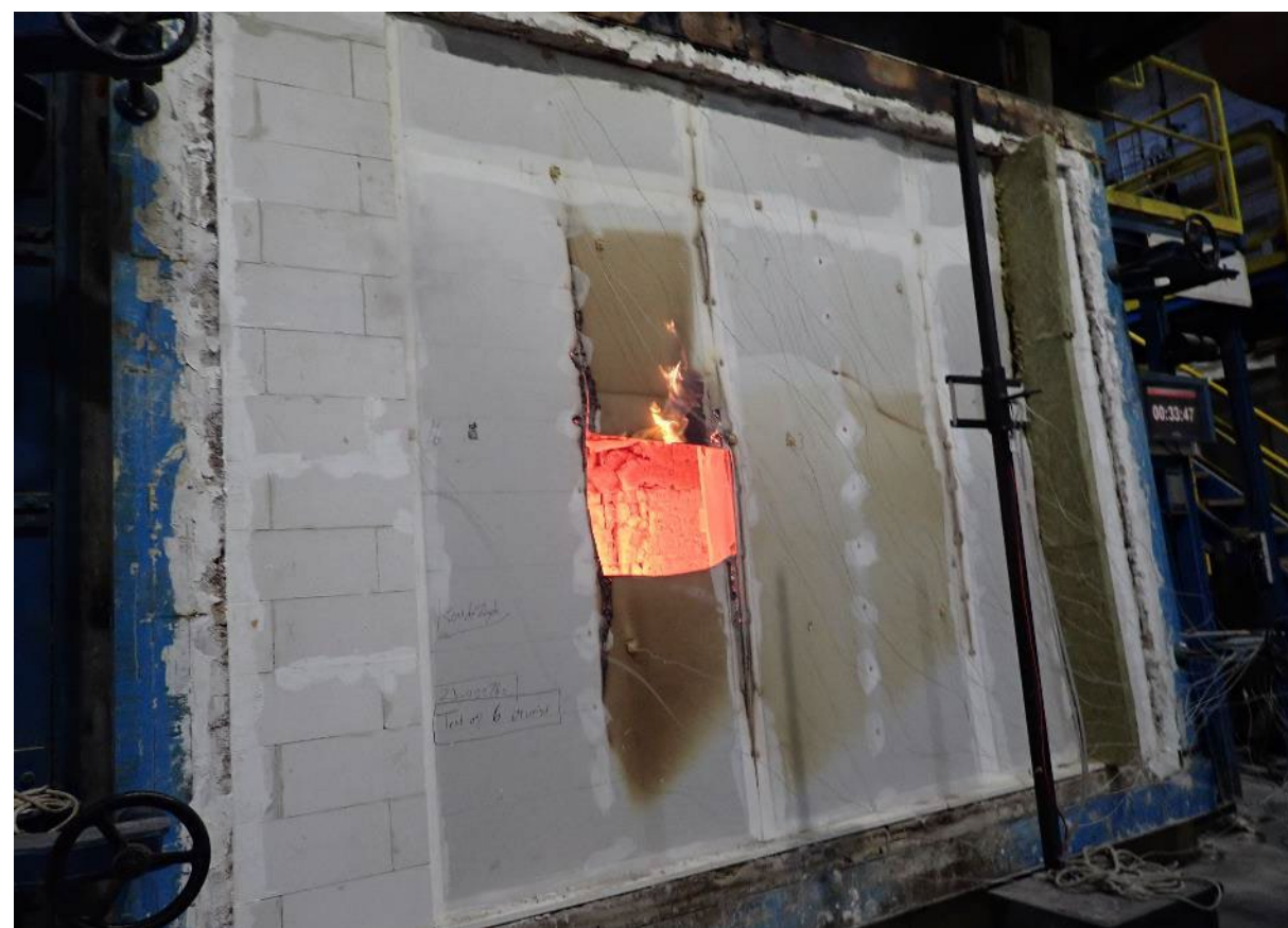
Foto C. 8: Proefstuk na 33 minuten verhitting (einde test na 34 minuten verhitting)
