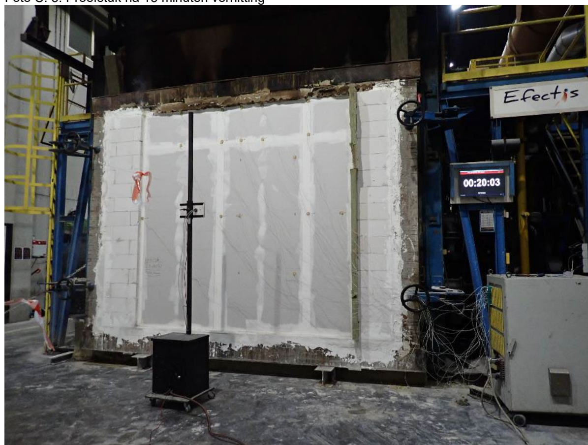
Foto C. 6: Proefstuk na 20 minuten verhitting
